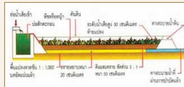
ลักษณะของแปลงระบบบำบัดน้ำเสียด้วยพืชและหญ้ากรอง
